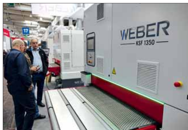
Bei den Schleifautomaten der Hans Weber Maschinenfabrik GmbH gibt das neue „Light Messaging System“ (LMS) auch über größere Distanzen Auskunft über deren Betriebszustand
