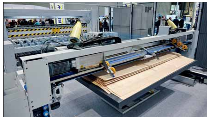
Bei der neuen Version der Kuper Quer-Zusammensetzungsmaschine „ACR 3200“ wurde der Hubtisch dichter an die Maschine herangerückt, der Support fährt bis über den Tisch. Dadurch nimmt die Maschine weniger Platz in Anspruch.
