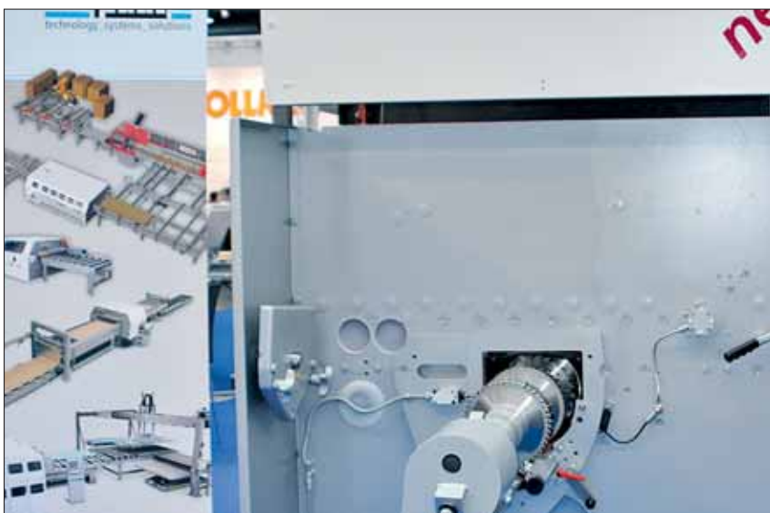
Säge- und Wetzwechsel leicht gemacht, durch ein neu entwickeltes „HSK“-Spannsystem von Paul.
