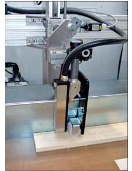
Kappen und bedrucken: Salvador zeigte eine „Superpush 250“ mit integrierter Druckeinheit (rechts), die berührungslos Markierungen, Barcodes oder Schriftzüge (kleines Bild) bei normaler Produktionsgeschwindigkeit aufs Holz druckt.
