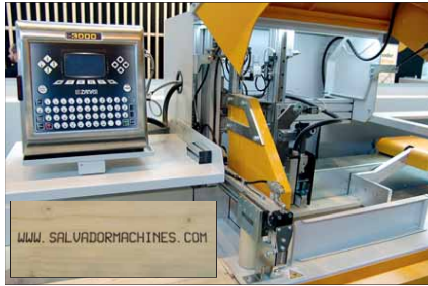
Kappen und bedrucken: Salvador zeigte eine „Superpush 250“ mit integrierter Druckeinheit (rechts), die berührungslos Markierungen, Barcodes oder Schriftzüge (kleines Bild) bei normaler Produktionsgeschwindigkeit aufs Holz druckt.
