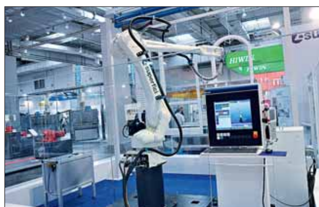
Abbildung 8 Superfici setzt auf einen Sechs-Achs-Kawasaki-Roboter mit zwei Spritzdüsen für einen optimalen Farbnebel und kürzere Zykluszeiten.
