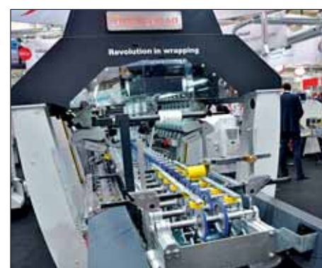
Abbildungen 10 und 11 Der „Robo Wrap“ von Cefla ist eine Folienkaschieranlage, die sehr schnell auf ein neues Profil umgerüstet werden kann. Jeder der 19 kleinen Sechs-Achs-Roboter hat eine Andruck-Rolle in seiner „Hand“, die in Summe so ausgelegt sind, eine Folie auf lange, schmale Teile aufzubringen.
