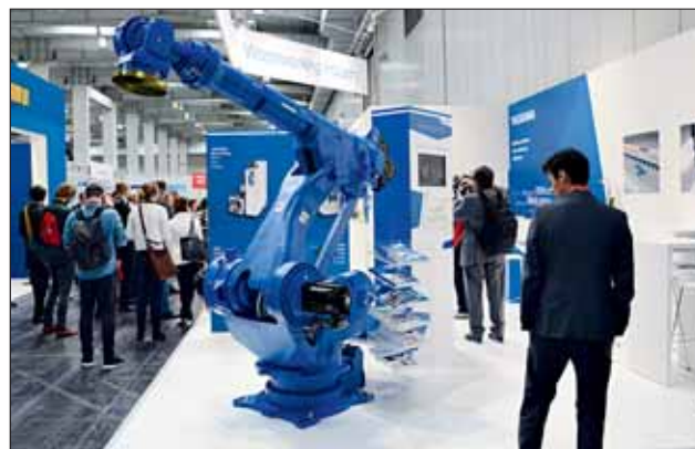
Abbildung 6 Mit der „Motoman MH“-Serie bietet Yaskawa flexible sechsachsige Hochgeschwindigkeits-Roboter für eine Vielzahl von Applikationen wie Handling, Maschinen-Beschickung, Verarbeitungs- und Verteilapplikationen bis hin zu Paletten-Reparatur-Systemen.
