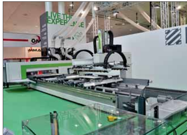
Abbildung 13 Der Manipulator „Synchro“ in der „Rover B Edge“ von Biesse nimmt die zu bearbeitenden Platten von einem Stapel, positioniert sie in Bezug auf einen Nullpunkt des Arbeitszentrums und legt sie nach der Bearbeitung an einem spezifischen Platz ab.
