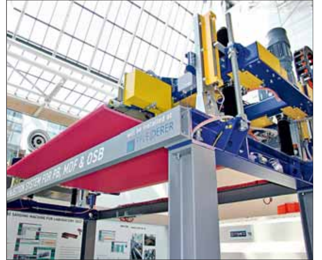
Das auf der Messe ausgestellte „Dynasteam“-System zur Mattenvorwärmung wurde nach der Messe in die Oberpfalz transportiert und dort bei Pfeleiderer in Neumarkt in einer Spanplattenlinie aufgebaut.
