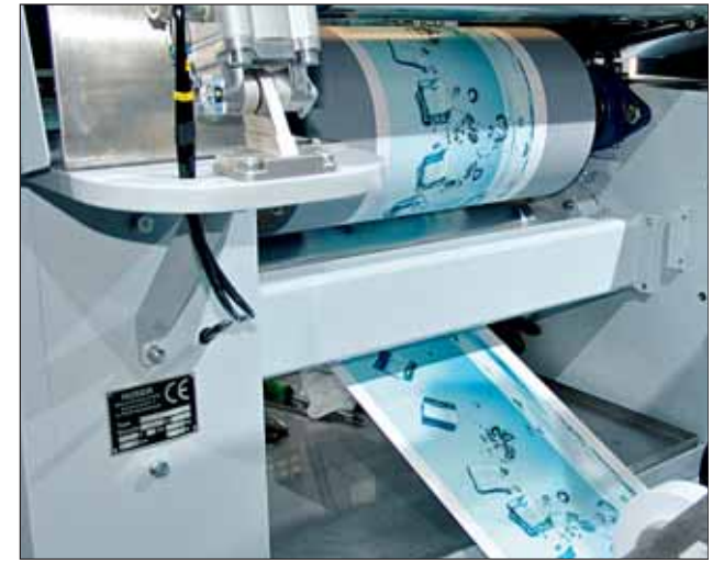
Weltpremiere am Stand von Kleiberit in Halle 15: Der Maschinenbauer Huser aus Herbolzheim in Baden hatte dort eine Inline-Digitaldruckanlage aufgebaut, die in einem Arbeitsgang Papier, PVC, Folien, ABS und OPP-Film bedrucken, mit „Hot Coating“ und „UV Top Coat“ beschichten und anschließend auch Strukturen mit einer Prägewalze aufbringen kann. Auf der in Hannover gezeigten Anlage konnten Papierbreiten von 400 mm mit einer Geschwindigkeit von 60 m/min verarbeitet werden. Geplant ist, die Anlagenbreite auf eine Druckbreite von 1,6 m auszuweiten.
