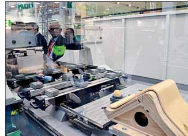
Abbildung 14 Der Arbeitstisch des neuen Biesse-Bearbeitungszentrums „Rover M5“ lässt sich individuell konfigurieren und kann auch sehr voluminöse Werkstücke problemlos spannen. Möglich ist ein Werkstückdurchgang von bis zu 535 mm.
