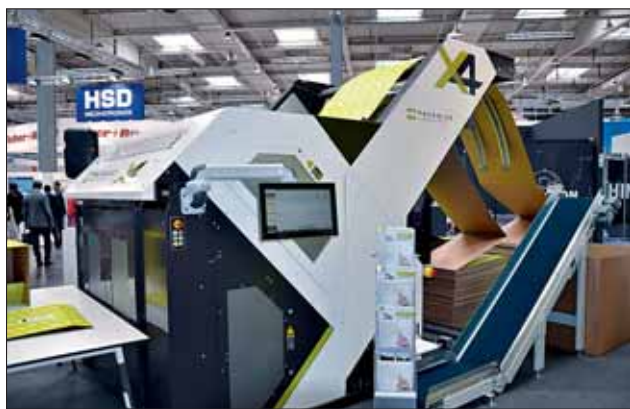
Das Steuerungs-Terminal ist bei der Verpackungsmaschine „X4“ von Packsize an einem seitlichen Schwenkarm platziert. Mit Hilfe eines Druckers ist es möglich, jeden fertig geschnittenen und perforierten Karton mit einem Etikett zu bekleben.
