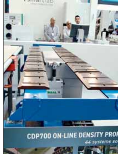
Beim Imal-System „CPD 700“ zur Online-Detektion des Rohdichteprofiles sind Röntgenstrahler wie Detektor unterhalb der Platte angebracht.
