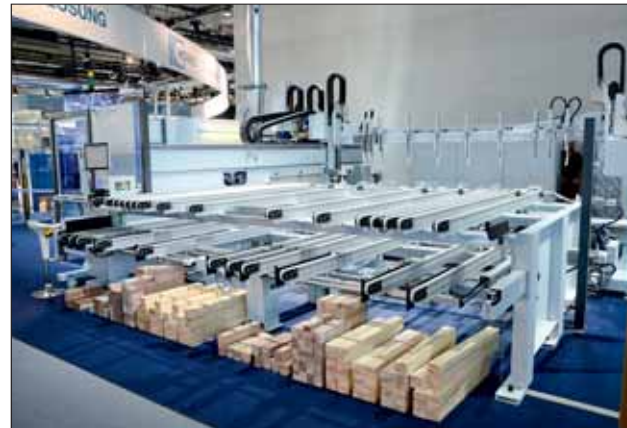
Abbildung 4 Das Homag Fenster-Zentrum „BMB 800/900 Power Profiler“ verfügt über einen Zusatz-Konsolentisch, der auch die Bearbeitung von Bogenelementen und Türen ermöglicht.
