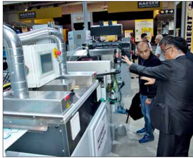
Weltpremiere am Stand von Kleiberit in Halle 15: Der Maschinenbauer Huser aus Herbolzheim in Baden hatte dort eine Inline-Digitaldruckanlage aufgebaut, die in einem Arbeitsgang Papier, PVC, Folien, ABS und OPP-Film bedrucken, mit „Hot Coating“ und „UV Top Coat“ beschichten und anschließend auch Strukturen mit einer Prägewalze aufbringen kann. Auf der in Hannover gezeigten Anlage konnten Papierbreiten von 400 mm mit einer Geschwindigkeit von 60 m/min verarbeitet werden. Geplant ist, die Anlagenbreite auf eine Druckbreite von 1,6 m auszuweiten.
