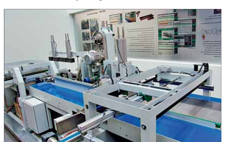
Imal präsentierte neu auf der Messe die „SMC 100“, ein vollautomatisches System, um Laborproben herzustellen. Dafür wird der abgesägte Plattenstreifen in die Anlage eingeführt und dann entsprechend der Vorgaben aufgetrennt. Integriert sind auch entsprechende Schleifaggregate zur Vorbehandlung der Probe. Die als gut befundenen Proben werden dann mit einem QR-Code versehen und können dann etwa in der „IB 700“ von Imal getestet werden.
