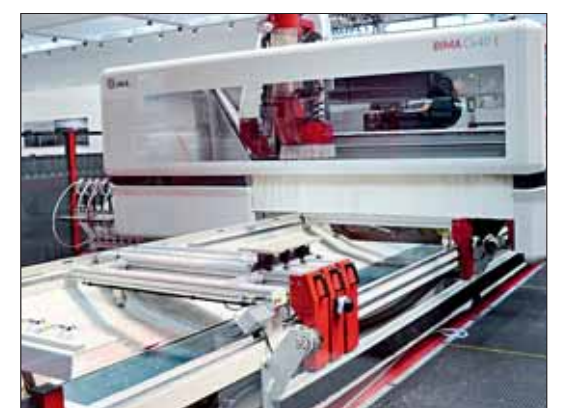
Abbildung 10 In eine verkettete Anlage von Ima wurde eine „Bima Cx40 Laser Edging“ integriert, die sämtliche Vollkonturplatten fräst und bekantet.
