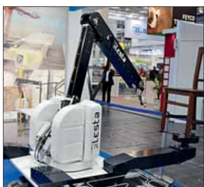
Abbildung 9 Preisgünstiger Sechs-Achs-Roboter „Le Bot MV“ mit relativ einfacher Konstruktion, in Eigenbau gefertigt von Lesta.
