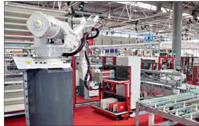
Abbildung 3 Ima zeigte wieder einen Industrieroboter, der ein kreisförmiges Regalsystem mit horizontaler Lage der Regalböden, deren Abstände zueinander flexibel sind.
