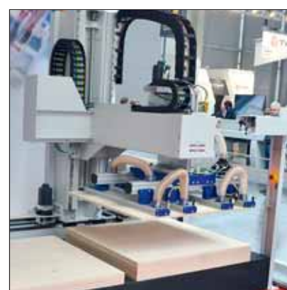
Abbildungen 8 und 9 Die CNC-Anlage „Vision-1“ von Reichenbacher-Hamuel kann Bauteile aus Massivholz, Holzwerk- und Kunststoffen bearbeiten. Sie wurde mit einem automatischen Beschickungssystem ausgerüstet, das über Stapelplätze und Lader verfügt (rechts).
