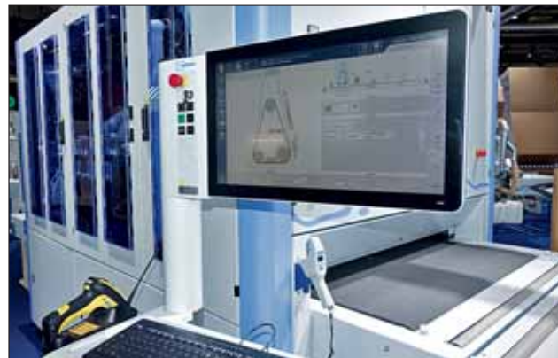
Bei der Homag-Gruppe standen die Themen leichte, intuitive Bedienung und Prozesssicherheit im Fokus der Messepräsentation. Auf einem 21 Zoll großen Display kann der Bediener via Touch- und Gestensteuerung jegliche Einstellungen an der Maschine vornehmen und ganz einfach, wie an einem Tablet, navigieren. Möglich wird dies durch die Bediensoftware „Power Touch“, die bei den Baureihen „SWT 300“ und „SWT 700“ standardmäßig implementiert ist.
