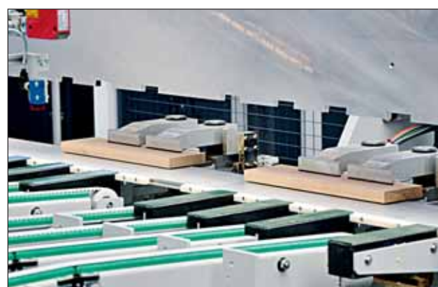
Abbildungen 5 und 6 Das „Conturex“-System von Weinig umfasst in der zweiten Generation eine breite Palette von CNC-Zentren für die Fensterfertigung. Als Neuheit wurden bei der „C 125 Vario“ (rechts) die Einlauf-Mechanisierung mit Parallelbeschickung und die vier „Vario“-Einzel-Zangentische mit je zwei Zangen vorgestellt.
