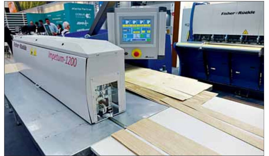
Die komplett überarbeitete Furnier-Längszusammensetzungsmaschine „Impetum 1200“ von Fisher + Rückle verfügt über sechs separat regelbare Heizzonen.
