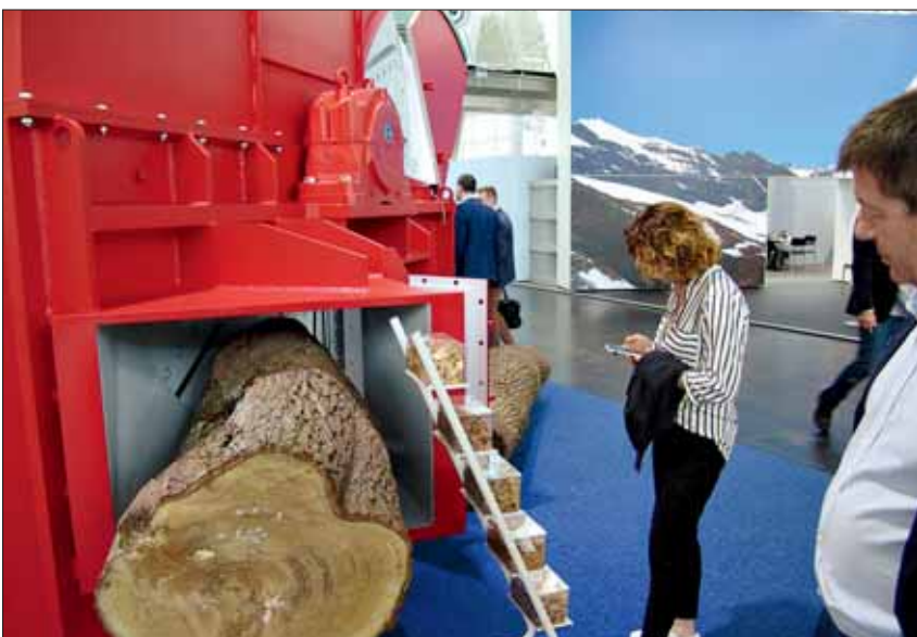
Am Stand von Pallmann war der neue Scheibenhacker „PHS 36 H15“ zu sehen. Es handelt sich dabei um das größte Modell, das jemals in der Siempelkamp-Gruppe gefertigt wurde. Die Scheibe misst im Durchmesser 3,6 m mit 15 Messern. Neu ist aber nicht nur die Größe, vor allem wurde das Antriebssystem komplett ausgetauscht und auf Elektromotoren umgestellt.
