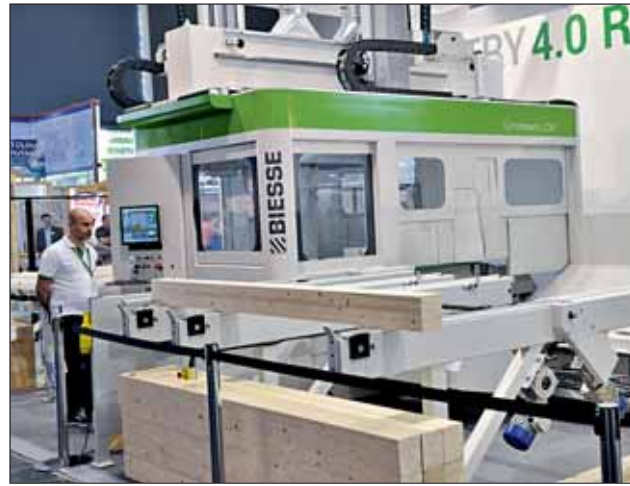
Abbildungen 11 und 12 Das BAZ „Uniteam CK“ von Biesse ist in der Lage, bis zu 14 m lange Balken mit Querschnitten bis zu 1000 x 300 mm zu bearbeiten. Das neue Multizentrum „Win Line 16“ für Handwerker und kleine Industriebetriebe produziert auf einfache Weise lineare Standard-Fenster und -Türen sowie Sonderlösungen, einschließlich Bögen (rechts).
