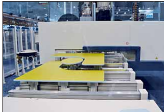
Abbildung 15 Die „Morbidelli P200“ von SCM ist ein BAZ zum Fräsen und Kantenanleimen, das vielen Firmen Lösungen bezüglich Übergröße und Formgebung bietet. Die Besonderheit liegt in der Organisation der Vakuumsauger, deren Position verschiedene Höhen-Einstellungen ermöglicht.
