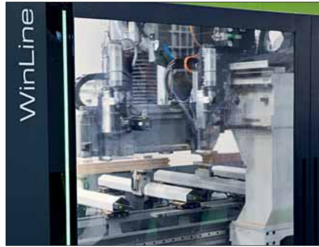
Abbildungen 11 und 12 Das BAZ „Uniteam CK“ von Biesse ist in der Lage, bis zu 14 m lange Balken mit Querschnitten bis zu 1000 x 300 mm zu bearbeiten. Das neue Multizentrum „Win Line 16“ für Handwerker und kleine Industriebetriebe produziert auf einfache Weise lineare Standard-Fenster und -Türen sowie Sonderlösungen, einschließlich Bögen (rechts).
