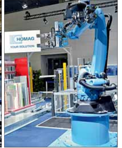
Abbildungen 1 und 2 Homag hat seine Zuschnitt-Zelle „HPS 320 Flex Tec“ mit Roboter und Aufteilsäge weiterentwickelt. Die Bohr- und Beschlag-Einsetzanlage „ABF 600“ (rechts) wird von einem selbständigen Roboter voll gemanagt. Fotos: Norbert Schmidt
