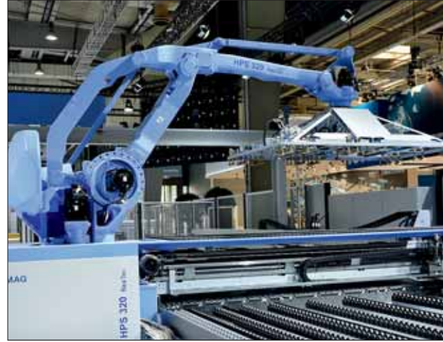
Abbildungen 1 und 2 Homag hat seine Zuschnitt-Zelle „HPS 320 Flex Tec“ mit Roboter und Aufteilsäge weiterentwickelt. Die Bohr- und Beschlag-Einsetzanlage „ABF 600“ (rechts) wird von einem selbständigen Roboter voll gemanagt. Fotos: Norbert Schmidt
