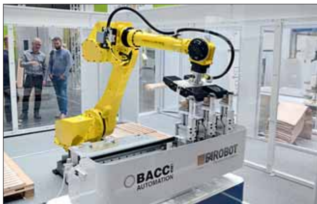
Abbildung 5 Bei der Roboter-Zelle von Bacci kommt der Fanuc-Roboter „M-710-iC-50“ zum Einsatz, der schmale Massivholzteile mit einem speziellen Greifer von einer Palette aufnehmen und in eine Vorrichtung der Bearbeitungs-Maschine einlegen kann.
