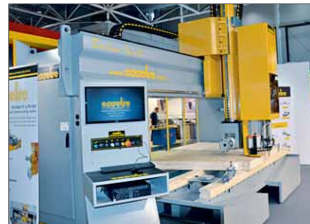
Abbildung 18 Bei dem Essetre-BAZ „Techno Wall“ handelt es sich um ein CNC-gesteuertes Bearbeitungszentrum mit fahrbarem Portal, das im Holzbau für Wand-Elemente eingesetzt wird.
