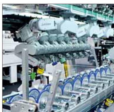
Abbildungen 10 und 11 Der „Robo Wrap“ von Cefla ist eine Folienkaschieranlage, die sehr schnell auf ein neues Profil umgerüstet werden kann. Jeder der 19 kleinen Sechs-Achs-Roboter hat eine Andruck-Rolle in seiner „Hand“, die in Summe so ausgelegt sind, eine Folie auf lange, schmale Teile aufzubringen.
