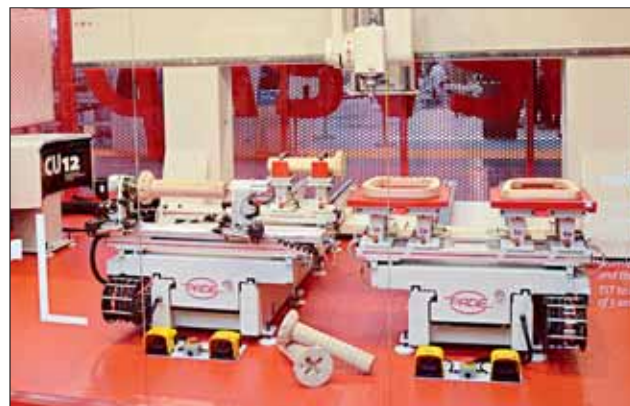
Abbildung 17 Das auf der „Ligna“ ausgestellte BAZ „Clipper L“ von Pade war mit dem T3-Fräskopf bestückt, der drei Spindeln hat und in einer Gabel-Halterung aus Aluminium positioniert ist. Als Messe-Neuheit war es mit zwei Werkzeug-Wechslern mit Tellermagazin ausgerüstet, die jeweils rechts und links angeordnet waren.
