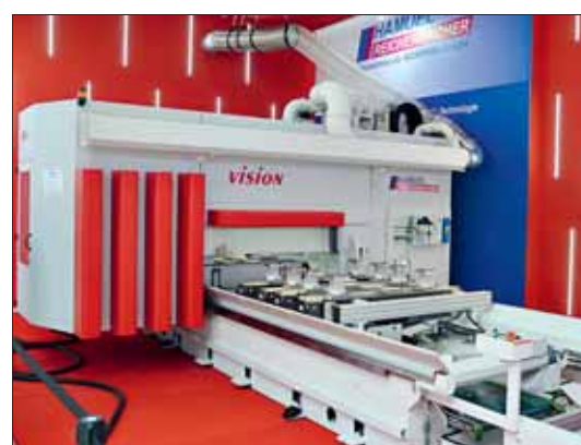
Abbildungen 8 und 9 Die CNC-Anlage „Vision-1“ von Reichenbacher-Hamuel kann Bauteile aus Massivholz, Holzwerk- und Kunststoffen bearbeiten. Sie wurde mit einem automatischen Beschickungssystem ausgerüstet, das über Stapelplätze und Lader verfügt (rechts).
