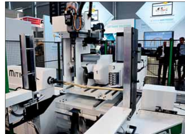
Abbildung 16 Das Bearbeitungszentrum „Mitika“ des italienischen Massivholz-Spezialisten Greda ist ein BAZ mit fünf interpolierenden Achsen, das speziell für den Einsatz beim Drehen oder Drechseln konzipiert ist.
