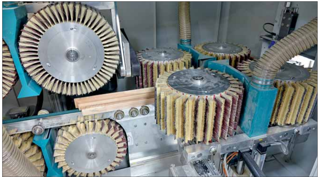
Grundlage einer perfekten Oberfläche ist ein möglichst perfekter Schliff. Das Angebot an entsprechender Technik für Industrie und Handwerk war groß in Hannover. Zu den gezeigten Maschinen gehörte auch die Profilschleifmaschine „Roba Fentech“, die MB Maschinenbau präsentierte. Fotos: Bolz (1), Ißleib (1), Krawczyk (6), Krüger (4)
