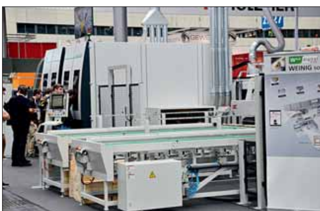
Abbildungen 5 und 6 Das „Conturex“-System von Weinig umfasst in der zweiten Generation eine breite Palette von CNC-Zentren für die Fensterfertigung. Als Neuheit wurden bei der „C 125 Vario“ (rechts) die Einlauf-Mechanisierung mit Parallelbeschickung und die vier „Vario“-Einzel-Zangentische mit je zwei Zangen vorgestellt.
