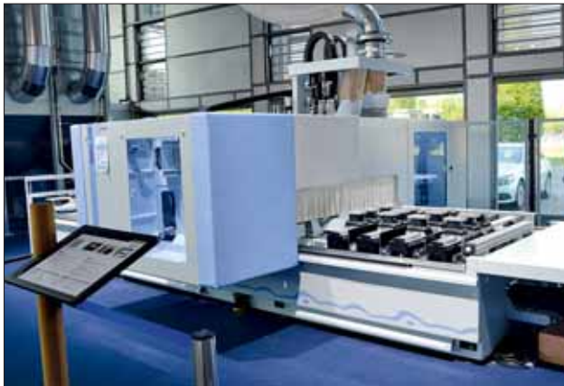
Abbildung 3 Die neue BAZ-Baureihe „BMG 310“ von Homag ist als robustes und stabiles Fahrportal in Stahl-Schweißkonstruktion ausgeführt und verfügt über zahlreiche Ausstattungsmöglichkeiten.
