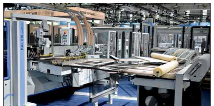
Abbildung 2 Moderne Kanten-Bearbeitungsmaschinen können ohne CNC-Technik ihre Aufgaben gar nicht erfüllen – dabei müssen sie, wie hier zu sehen ist, 48 verschiedene Kanten managen (Homag).
