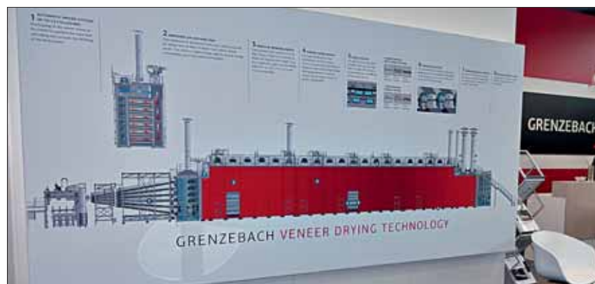
In einem selbstbewussten Rot zeigt sich der Grenzebach-Bandtrockner an der Wand des Messestandes. Ein solcher Trockner mit „Sinus“-Führung wird derzeit bei der Pollmeier-„Baubuche“ im Werk in Creuzburg in Betrieb genommen.
