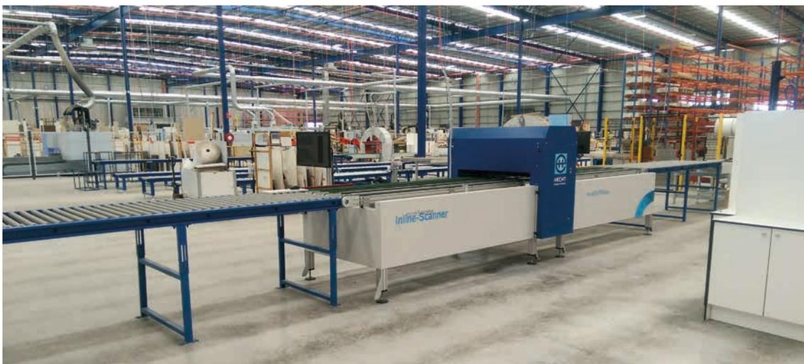
◀ Inline-Scanner bieten als Durchlaufmesstische eine lückenlose Nachvollziehbarkeit von Produkt- und Prozessdaten
