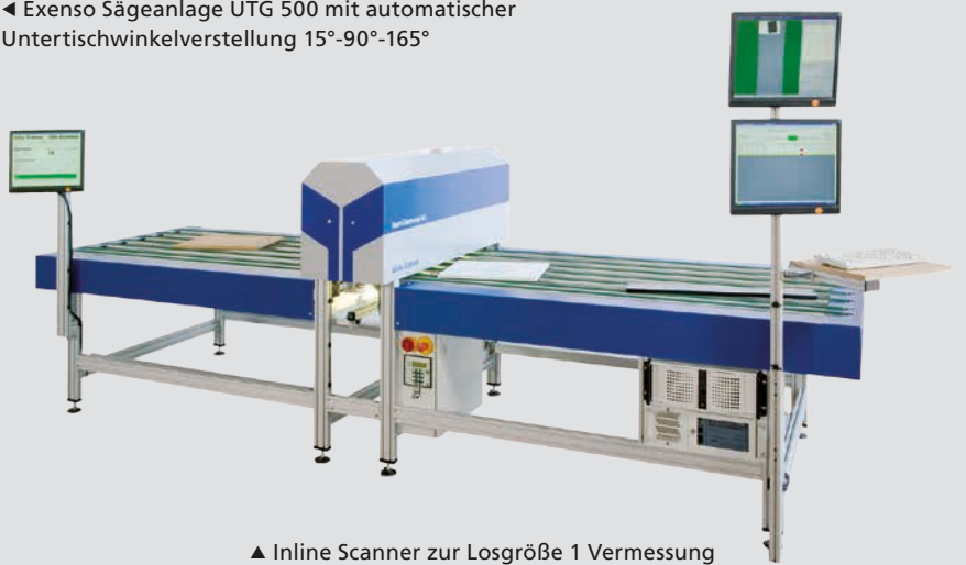
▲ Inline Scanner zur Losgröße 1 Vermessung
