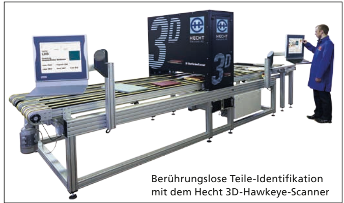
Losgrößen-1-Kontrolle: neben Außenmaß- und Winkelvermessung ist auch die beidseitige Bohrlochvermessung möglich
