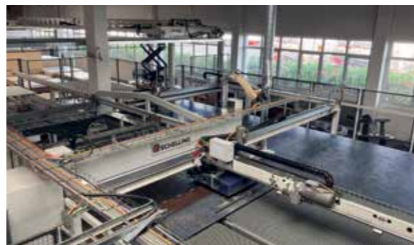
Die Plattenaufteilsäge „ls1“ von Ima Schelling ist eine ideale Wahl für eine Losgröße-1-Produktion.
