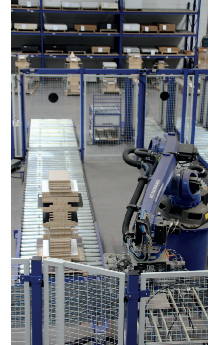
Auslagerung aus dem Pufferlager und kommissionsbezogene Stapelung der Werkstücke per Roboter: Die Teile laufen anschließend weiter in Richtung Bohrautomat und Montage.
