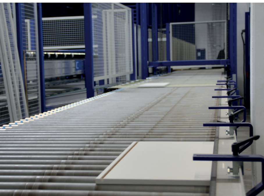
Nach Kontrolle durch den Inline-Scanner von Hecht Electronic laufen alle fehlerfreien Werkstücke in den Pufferspeicher. Teile mit Makel werden in einen Kettenspeicher ausgeschleust zur Nachkontrolle durch einen Mitarbeiter.
